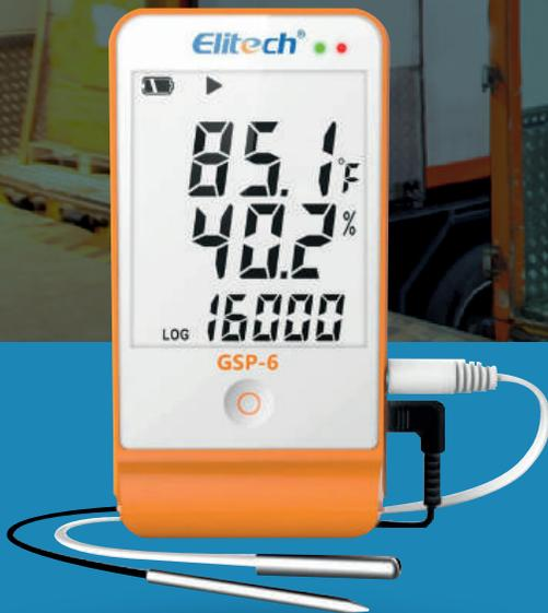
El GSP-6 está equipado con sensores externos de temperatura y humedad de alta precisión. Es adecuado para controlar la temperatura y la humedad en aplicaciones diarias. Tienen imanes integrados. Puede acoplarlos directamente sobre piezas metálicas. Por seguridad, estos registradores de datos cuentan con una alarma sonora y visual en caso de sobrepasar el límite.
