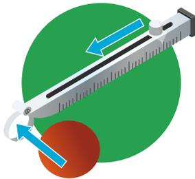
**A.** Expanda y coloque la fruta en la cinta del calibre.
