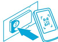
Al finalizar el viaje, inserte el termógrafo en el puerto USB de una computadora
